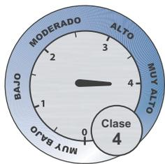
Ensayo según norma UNE-EN 1026:2000
